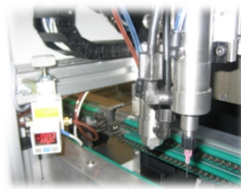
SISTEMA DE CONTROL DE PRESIÓN DE PULVERIZACIÓN
