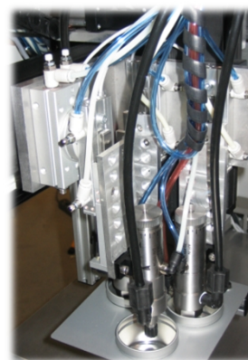
VÁLVULAS EN LAS CUBETAS DE APARCAMIENTO
